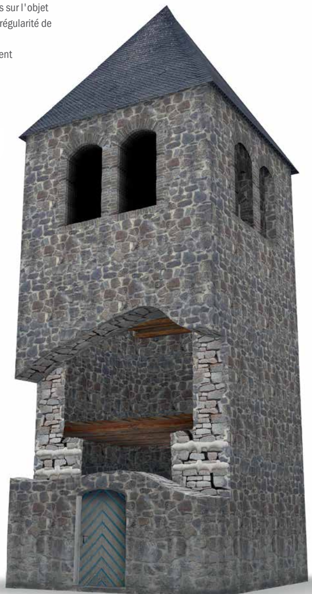
Verbindung abgelöster Mauerwerkschalen Raccordement des murs séparés
