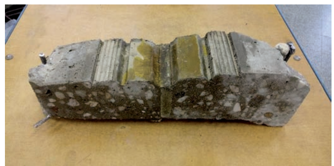
Bild 13 Injektionsgut auf der Rückseite eines Dehnfugenbands Injection material on the backside of an expansion joint tape
