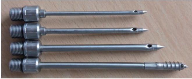
Bild 1 Injektionsbohrnadeln: 3, 4 und 5 mm Durchmesser; Gewindenadel Injection drilling needles: 3, 4 and 5 mm diameter, needle with threaded head
